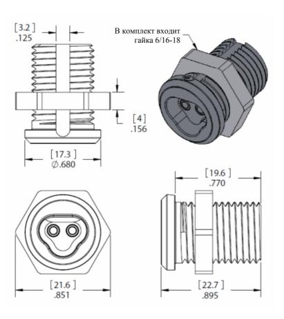
Примечание: Размеры приведены в дюймах (мм) На чертеже не соблюдены пропорции Ø указывает на диаметр
