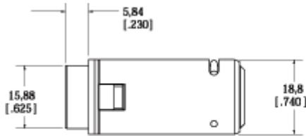
**Цилиндр для замков торговых автоматов, с пружинной защёлкой, для внешней установки.**
