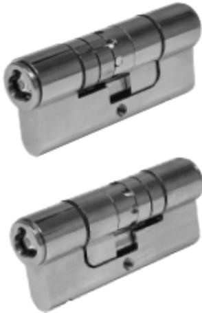
Двойной профильный цилиндр является одним из заменителей профильного цилиндра для замков европейского стандарта, в данном случае для цилиндра с двусторонним открыванием. На нём имеется две скважины и расстояние от центра до передней кромки, как и до задней кромки составляет 35 мм.
