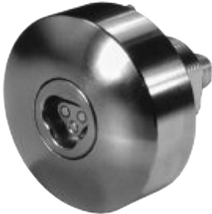
Цилиндр CyberLock IPS 40 мм это нестандартная модификация стандартного кулачкового замка. Внешняя оболочка изготовлена из никелированной латуни. Электроника сердцевины заключена в корпус из никелированной стали. На корпус нанесена резьба типа double-D диаметром 19 мм с шагом 1 мм. На сухаре цилиндра нанесена резьба диаметром 8 мм с шагом 0,8 мм.
