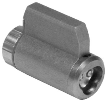
Электронный 6-пиновый цилиндр CyberLock основан на точном соответствии размерам механического цилиндра в формате Schlage. Он совместим со всеми замками, которые используют цилиндры этого типа. Электронная часть цилиндра заключена в сердцевину из нержавеющей стали с лицевой частью и контактами из нержавеющей стали. Внешняя оболочка изготовлена из латуни.
