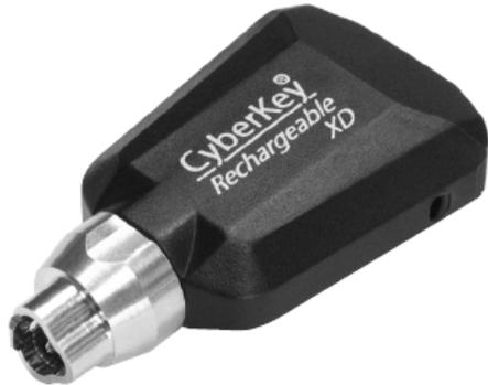
Подзаряжаемый сверхпрочный ключ CyberKey представляет собой электронный ключ, который используется для открывания замков CyberLock. У него бронзовый наконечник с контактами из нержавеющей стали. Корпус ключа изготовлен из нейлона, усиленного стекловолокном, а колпачок отсека батареи - из поликарбоната. Световой индикатор указывает на заряд батареи и активность ключа.
