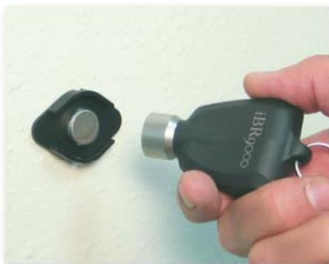
Ударопрочный корпус из усиленного стекловолокном нейлона обеспечивает исключительную защиту электронной внутренней части, а считывающая головка изготовлена из нержавеющей стали. Этот считыватель выдерживает повторяющиеся падения с высоты 1,8 м.
